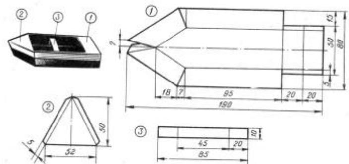
Рис. 1. Модель лодки-плоскодонки: 1 – корпус лодки; 2 – носовая часть; 3 – банка.
